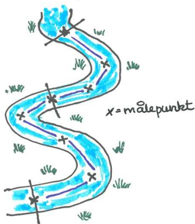
Figur 4: Punktmålinger i forbindelse med stationering af vandløb
